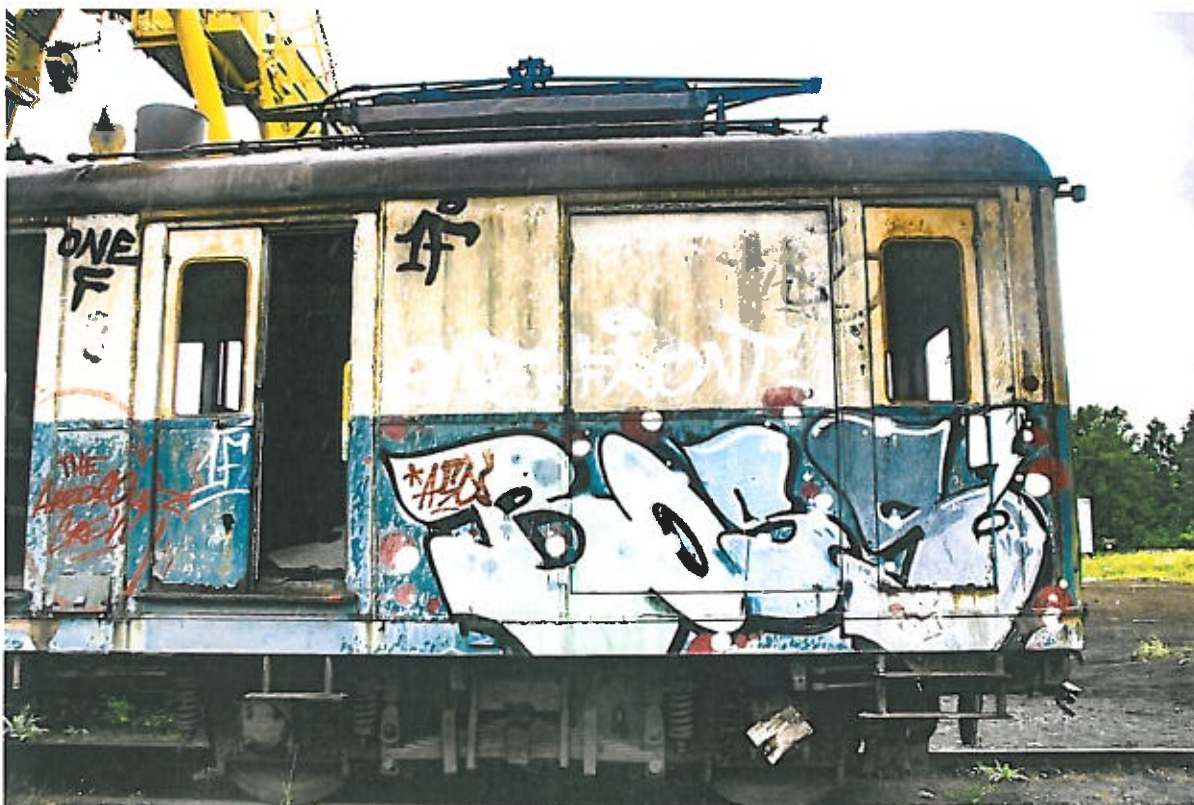
Rysunek 14: Bok EW51. Widoczne drzwi maszynisty, drzwi do przedziału konduktorskiego, oraz drzwi umożliwiające dostęp do silnika.
