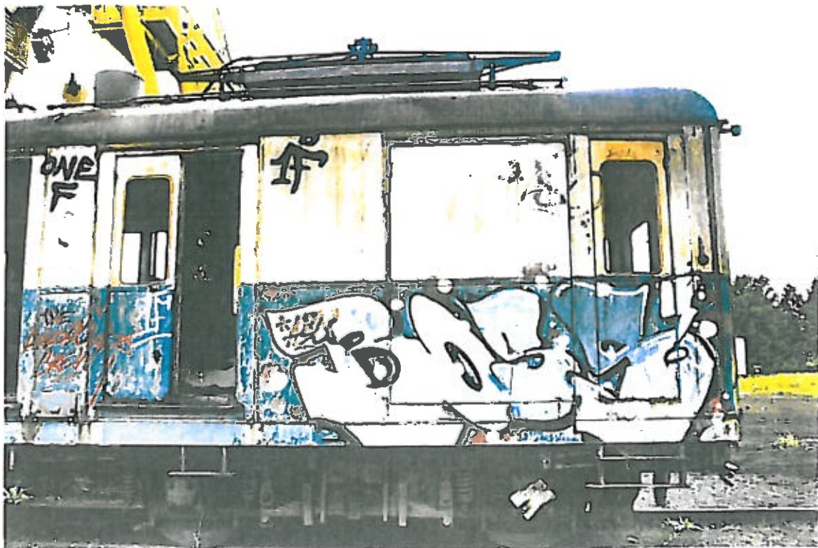
Rysunek 24: Bok EW51. Widoczne drzwi maszynisty, drzwi do przedziału konduktorskiego, oraz drzwi umożliwiające dostęp do silnika. Fot. P. Ratajczyk
