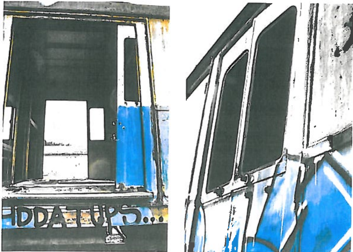
Rysunek 22: Zachowane skrzydła drzwi automatycznych (po lewej), oraz drzwi do przedziału konduktorskiego z dobrze widocznymi otworami na kłamek (po prawej). Fot. P. Ratajczyk
