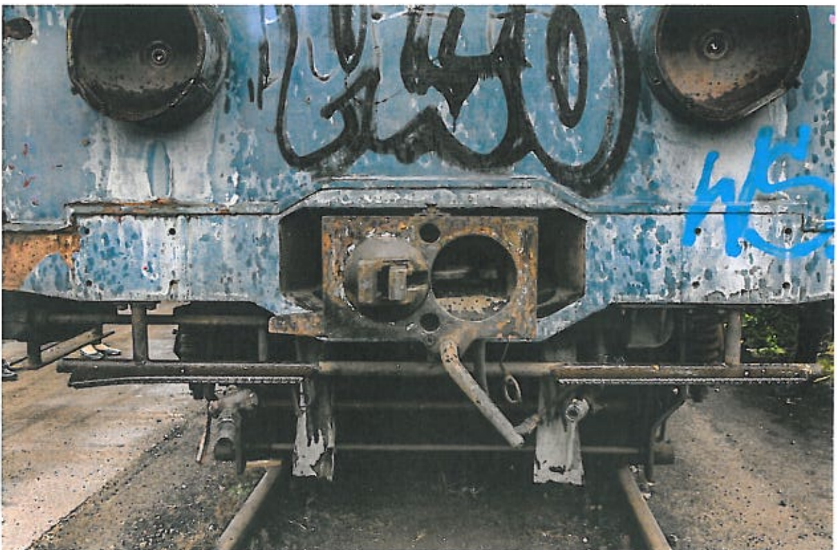
Rysunek 8: Sprzęg z przodu
