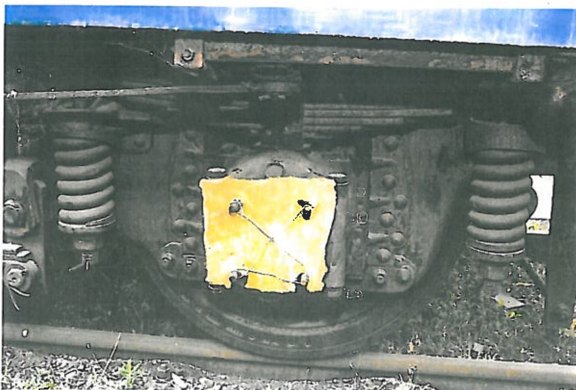
Rysunek 18: Przykład prawizorycznego zakrycia braku dekla maźnicy. Fot. P. Ratajczyk
