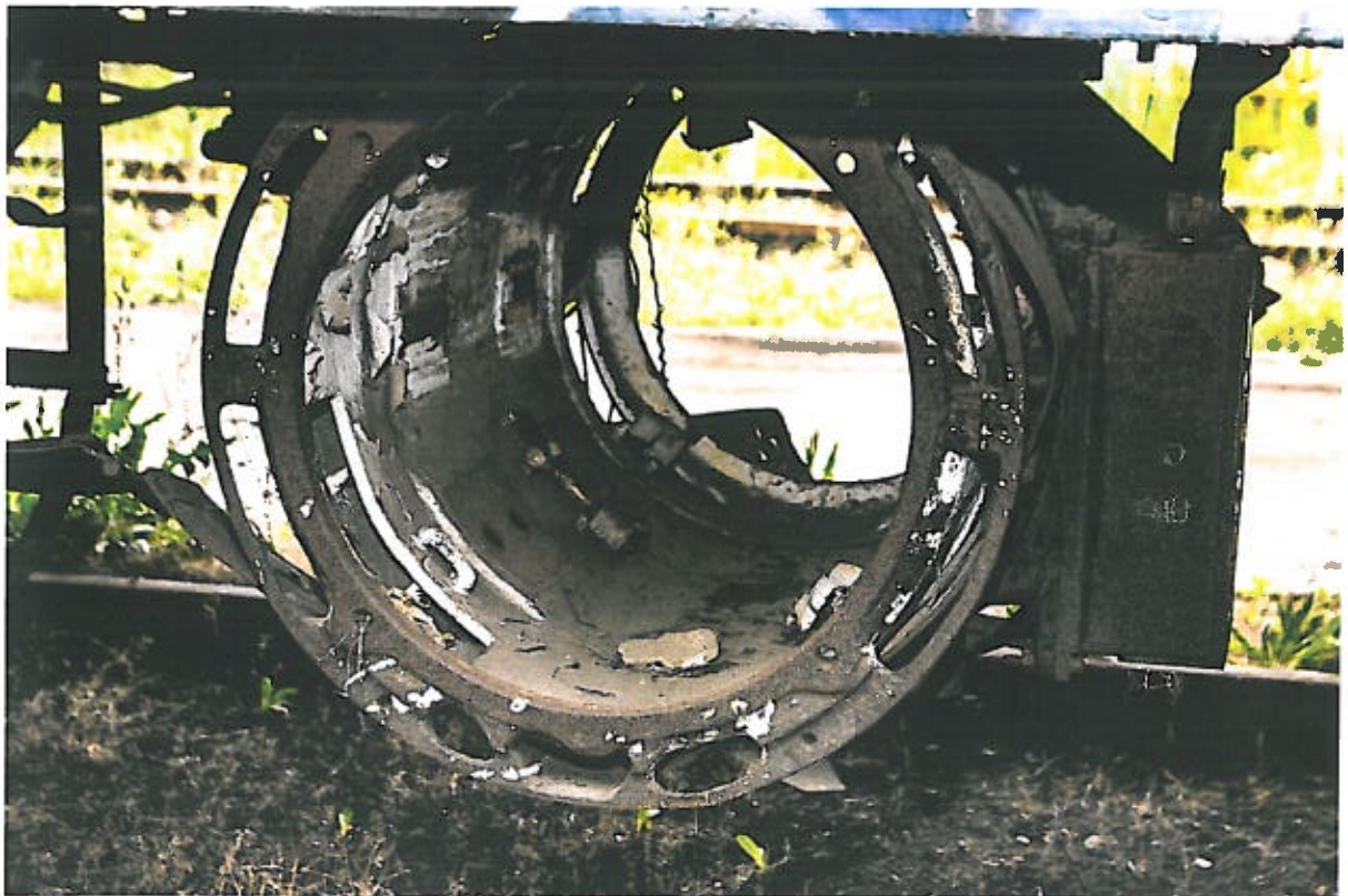
Rysunek 24: Pozostałości silnika umieszczone pod podłogą wagonu.
