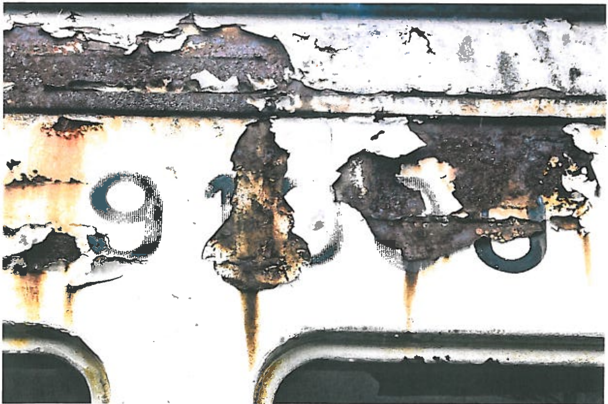
Rysunek 22: Szczegółowe zdjęcie zachowania powłoki malarskiej w miejscu naniesienia numeru pojazdu.
