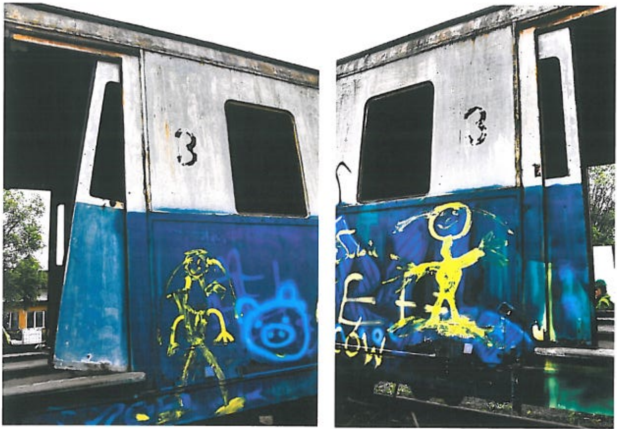
Rysunek 9: Pozostałości numeracji, widoczne zachowane skrzydła drzwi.
