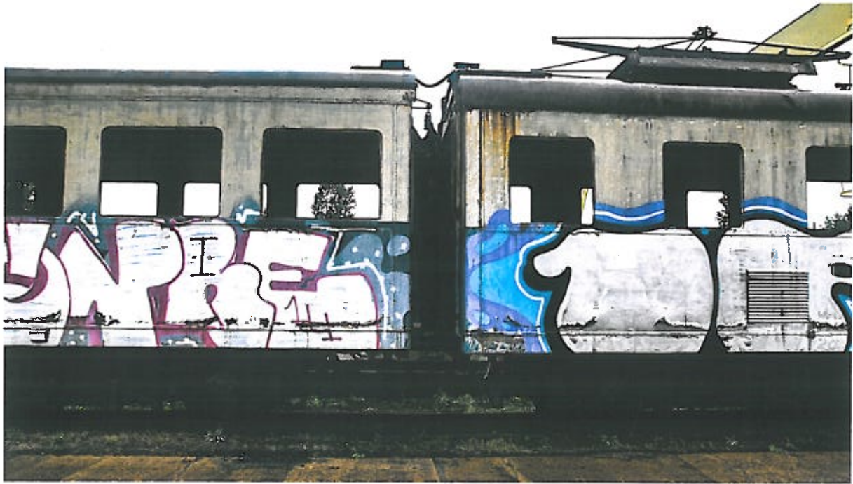
Rysunek 19: Bok EW51. Widoczne gumowe łączenie wagonów.
