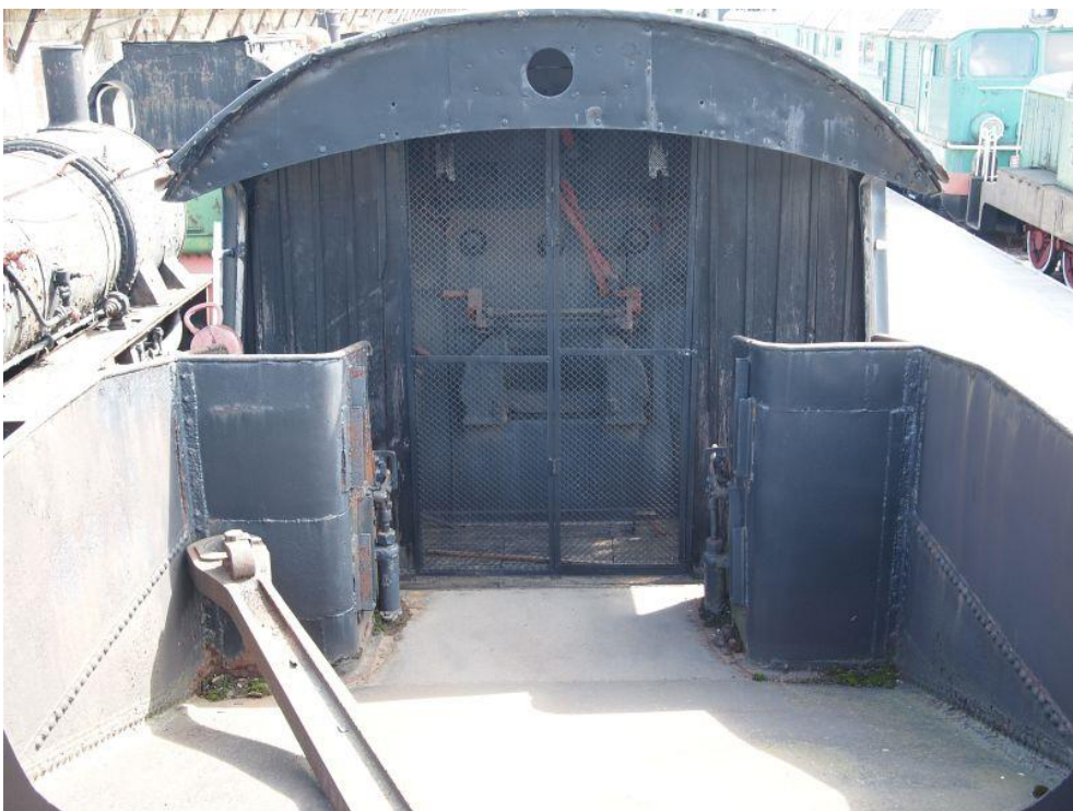
Fot. 25: Wnętrze skrzyni węglowej.
