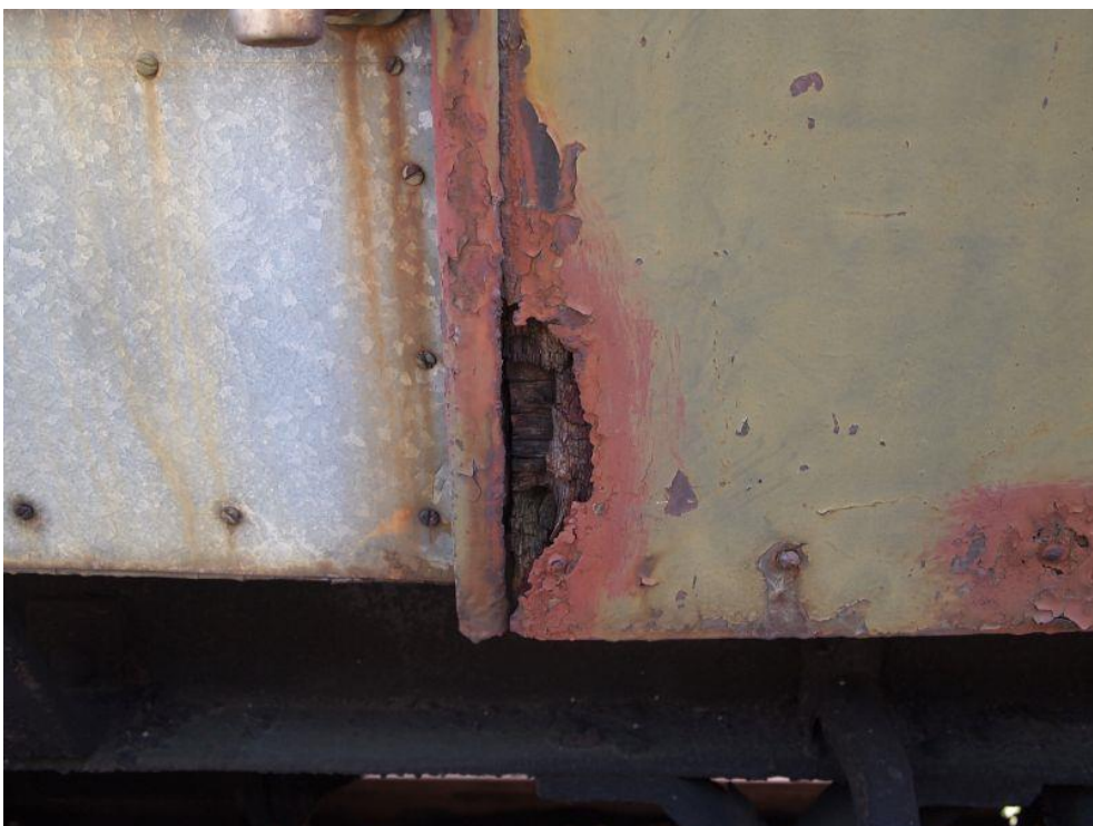
Fot. 54: Korozja i perforacja podłogi wagonu.
