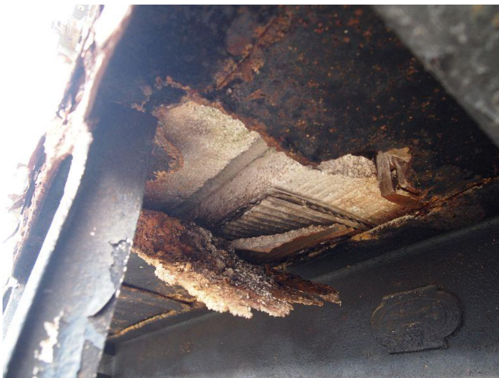
Fot. 49: Uszkodzenie podłogi wagonu (widoczna izolacja).
