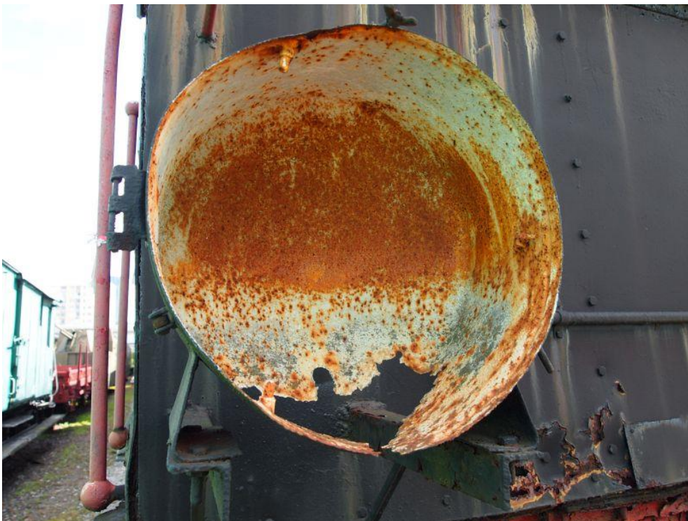
Fot. 9: Uszkodzenia tylnego lewego reflektora.
