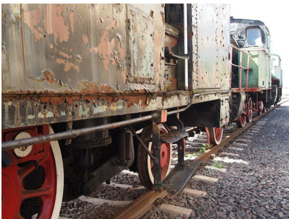
Fot. 14: Korozja na styku budki maszynisty i ostojnicy.
