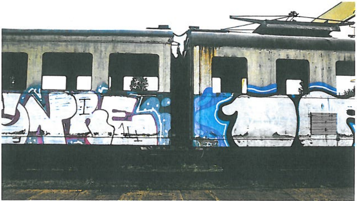
Rysunek 29: Bok EW51. Widoczne gumowe łączenie wagonów. Fot. P. Ratajczyk
