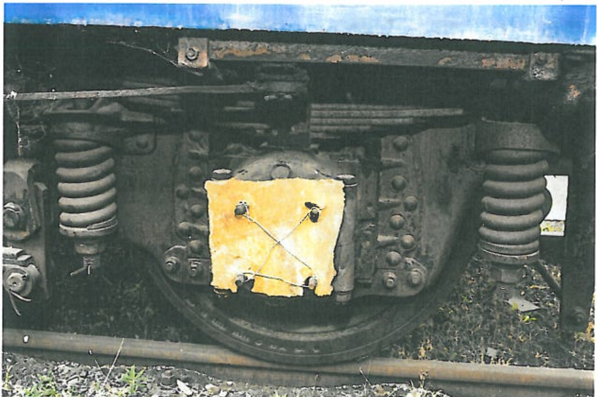
Rysunek 18: Przykład prowizorycznego zakrycia braku dekla maźnicy. Fot. P. Ratajczyk
