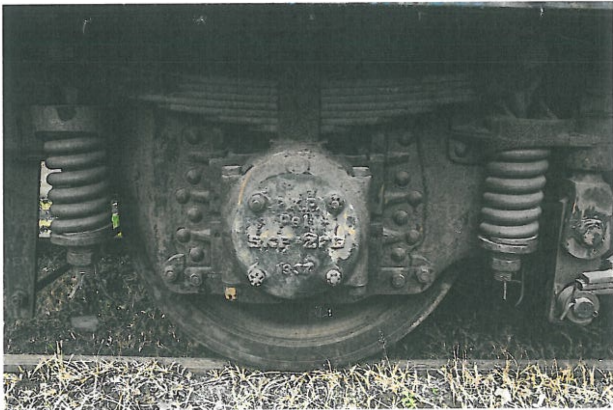
Rysunek 16: Zestaw kołowy PKP Ps1 1937. Fot. P. Ratajczyk
