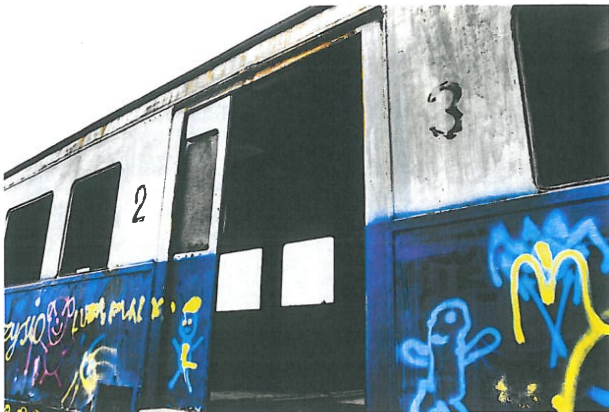
Rysunek 31: Bok EW51. Widoczne zachowane skrzydła drzwi. Fot. P. Ratajczyk
