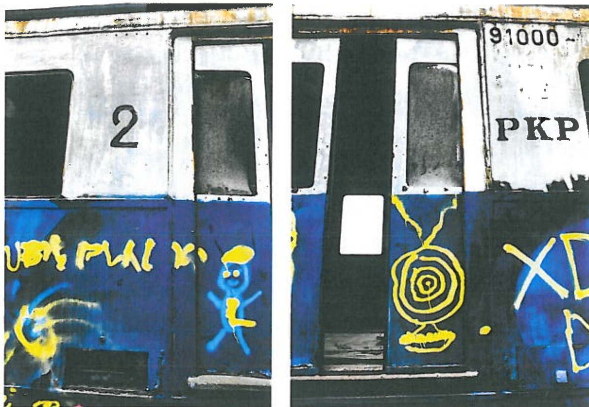
Rysunek 21: Pozostałości numeracji, widoczne zachowane skrzydła drzwi. Fot. P. Ratajczyk
