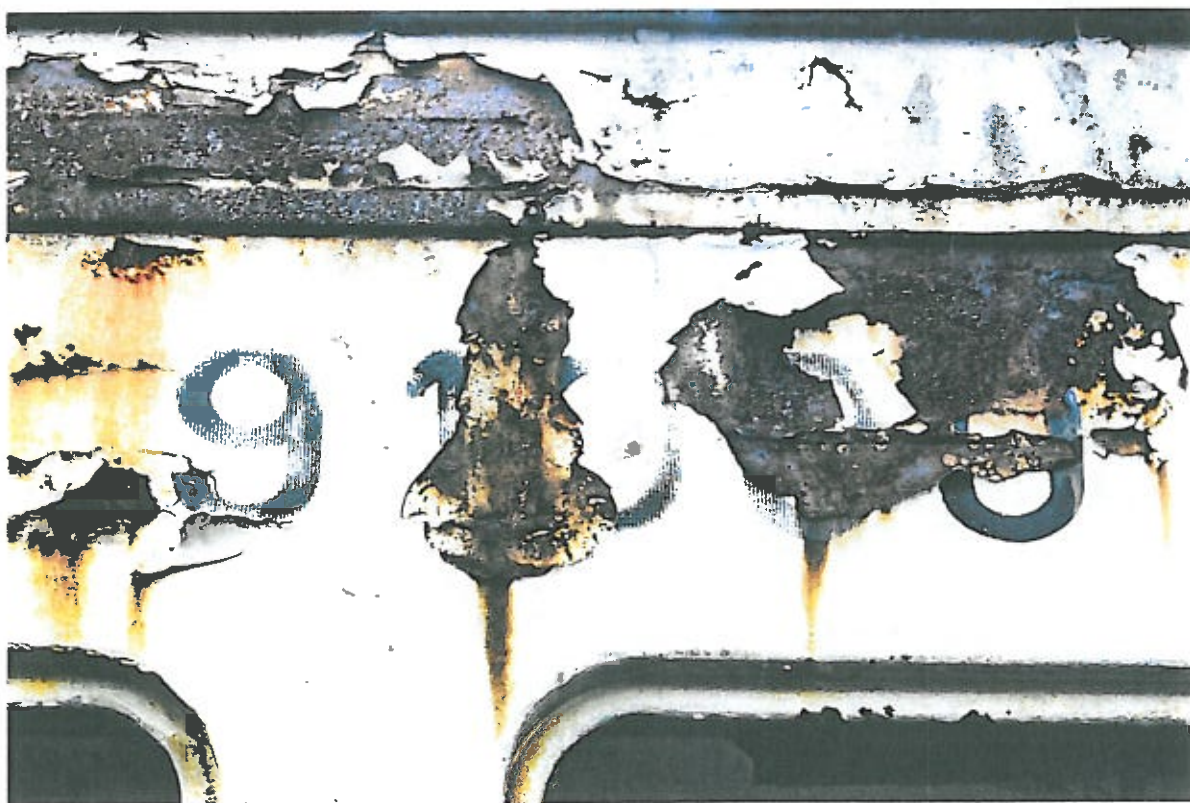
Rysunek 32: Szczegółowe zdjęcie zachowania powłoki malarskiej w miejscu naniesienia numeru pojazdu. Fot. P. Ratajczyk
