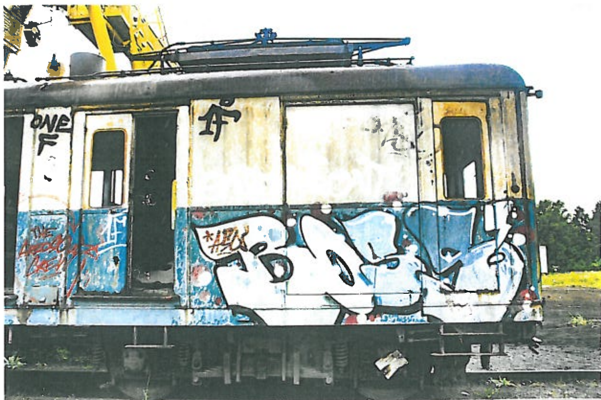
Rysunek 24: Bok EW51. Widoczne drzwi maszynisty, drzwi do przedziału konduktarskiego, oraz drzwi umożliwiające dostęp do silnika. Fot. P. Ratajczyk
